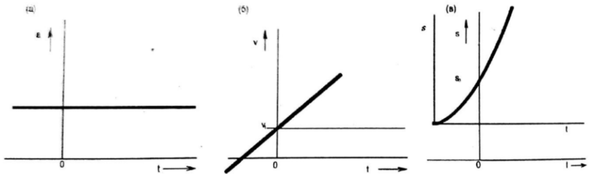
Слика 2-4: (а) Промена убрзања, (б) брзине и (в) пређеног пута електрона са временом у хомогеном електричном пољу
