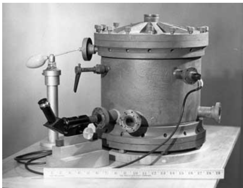
Слика 4-1: Изглед Миликеновог експеримента помоћу којег је посматрао капљице уља
